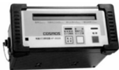
Một loại thiết bị phát hiện khí độc (có thể phát hiện khí CH 4 , H 2 S, Co và mật độ O 2 )
